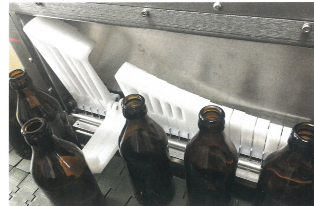
Segment-Ausleitsystem miho Leonardo SFM: Durch seine 24 Ausleitsegmente, welche sich schnell ein- und ausklappen, können fehlerhaft und ungeeignete Behälter problemlos, ohne die vorausstehenden oder nachfolgenden Behälter zu berühren, ausgeleitet werden.
